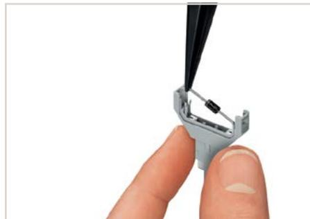
用于构建客户特定电路的元件插头。无须焊接即可组装二极管、电阻等组件。
