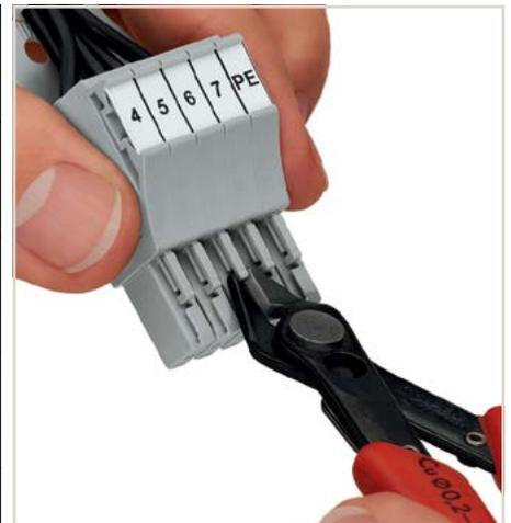
孔型连接器的防插错保护: 可利用合适工具将孔型连接器上的防插错定位销扭断。
