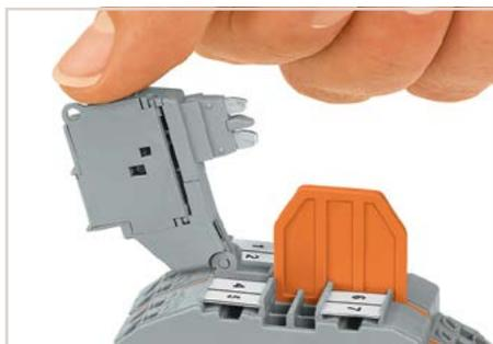
双层保险丝接线端子(2002-2611,灰色),带有可分断的保险丝盒,可与可断开式接线端子、基础接线端子、普通接线端子及保护接地端子组合使用。该接线端子的保险丝盒内还可安装LED熔断指示灯。(例如：2002-2611/1000-541适于12 ... 30 V)。
