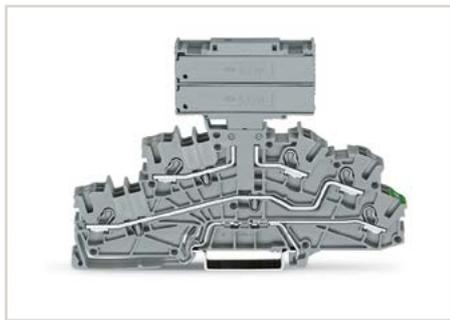
带G型保险管(5 x 25 mm)的双保险丝插头，适于标准宽度且不带刀型分断器的基础接线端子。
