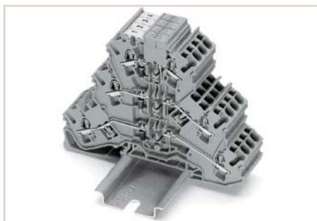
带二极管的三层接线端子专门用于建立二极管电路，如：灯泡测试电路和集中报警显示电路等。接线端子厚度仅为5.2 mm，实现了较高的紧凑性。而梳状跨接器的应用也更加便于建立特定电路。
