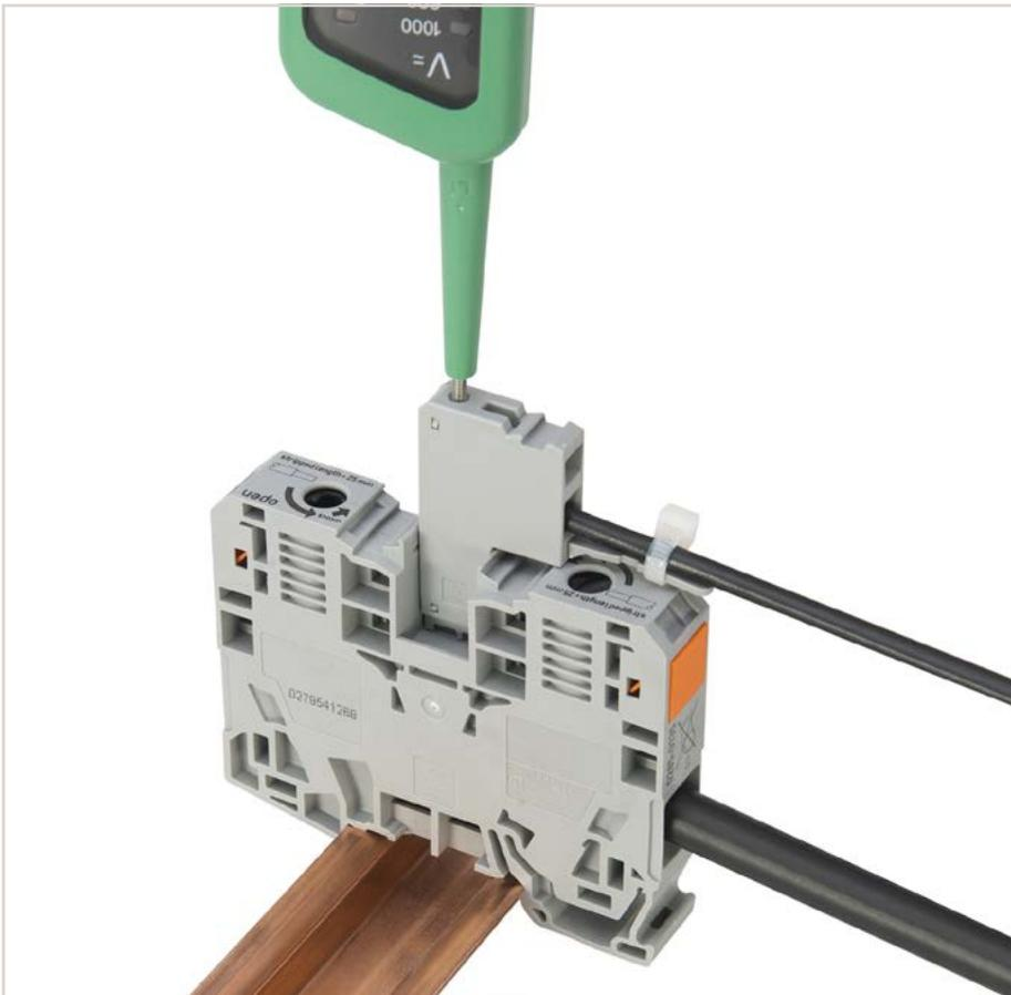
高低跨接器可在不同大小的接线端子之间进行跨接，而不会占用接线位。它可有效解决使用导线连接时产生电压降的问题。且可将一条较粗的导线轻松与较细的导线连接起来，以满足配电需要。
