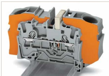
高低跨接器(2016-499)用于在 $16/10\text{ mm}^2$  (16/8 AWG)接线端子(2016/2010系列)与 $10/6/4/2.5\text{ mm}^2$  (8/10/12/14 AWG)接线端子(2010/2006/2004/2002系列)之间进行高低跨接。
