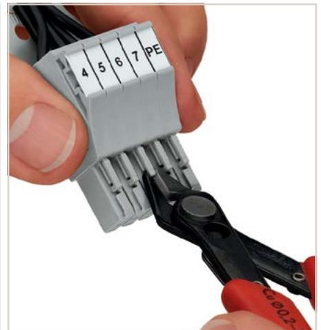
孔型连接器的防插错保护——可利用合适工具将孔型连接器上的防插错定位销扭断。
