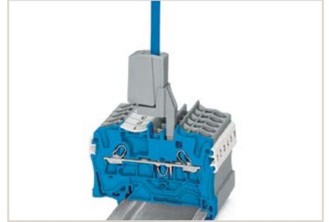
测试插头(2009-182)适用于2000至2016系列端子，可无需工具连接截面积最大为2.5mm<sup>2</sup> (12 AWG)的导线。
