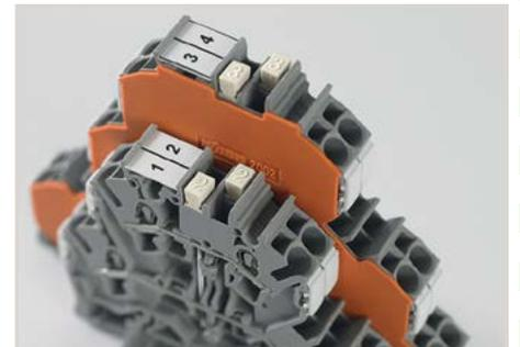
专为TOPJOB® S轨装式接线端子设计的垂直跨接器可对两层或三层接线端子进行跨接。凭借产品表面清晰的数字标识("2"和"3"), 即使在插入状态也可轻松辨别双层垂直跨接器(2002-492)和三层垂直跨接器(2002-493)。
