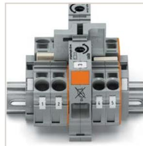
使用高低跨接器对35 mm<sup>2</sup> (2 AWG)大电流接线端子和10/16 mm<sup>2</sup>(8/6 AWG)TOPJOB® S接线端子进行跨接。
