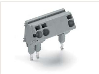
TOPJOB® S测试插头可直接插入进线孔，也可无需工具轻松拔出。由于多层接线端子在组装状态下跨接器插孔不易插入，所以该测试插头可作为便捷的替代方案。此外，您还可以使用间隔模块，将不需要插接连接器模块的端子跳过。
