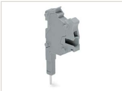
采用直插型笼式弹簧连接技术的模块化接插式连接器可以连接与相连接线端子相同截面积范围的导线，从而提供了额外的接线可能性(最大23A)。同时，其也可作为测试插头使用。
