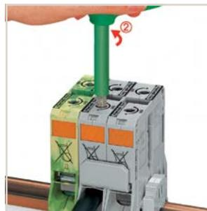
将扳手逆时针稍转一下②，插锁自动解开。此时便可将扳手移开，导线已经被牢牢地连接到端子上。
