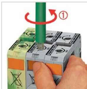
使用T型内六角扳手逆时针旋转打开进线孔①。然后按下橙色插锁，进线孔被锁定在打开位置，此时可空出双手进行接线。
