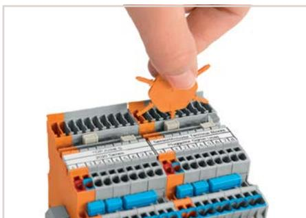
将防插错装置的定位销条插入到相应插孔中，然后将其扭断。
