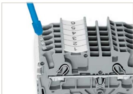
加有冷压接头的细多股导线：从低于额定截面积最多2个等级到额定截面积，均可无需接线工具直接插入。
