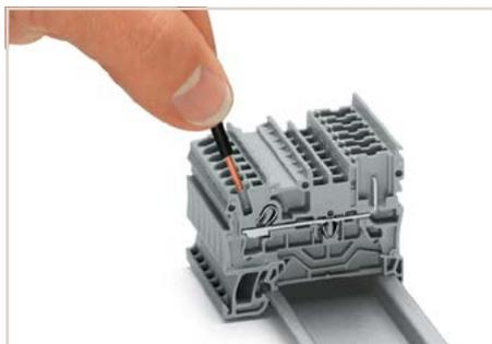
直插型笼式弹簧连接技术可轻松连接单股导线及带有冷压接头的细多股导线。
