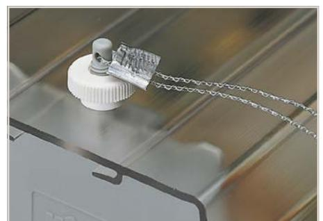
已被铅封锁定的防护罩
