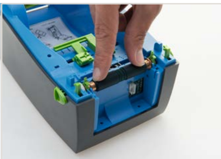
固定安装合适的轧辊
