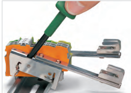
使用3型(5.5x0.8)mm操作工具将汇流条接地支架从导轨上拆下
