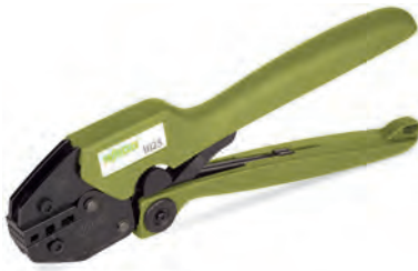
压线钳25, 适用于带/不带绝缘护套的冷压接头 压线范围: 10 mm 2 , 16 mm 2 和25 mm 2
