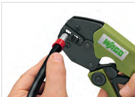
将加有冷压接头的导线插入压线孔。
