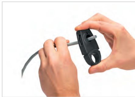
进行剥线操作
