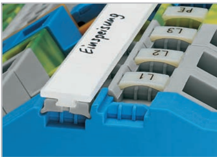
WFB标记条支架， 每10个接线端子可安装1个。
