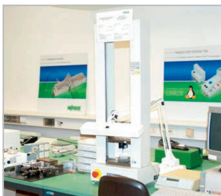
导线拉拔力试验
