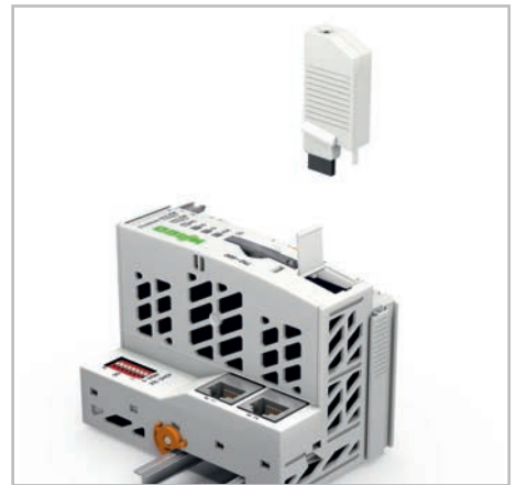
配置现场总线适配器的服务接口,通过配置电缆或无线适配器连接
