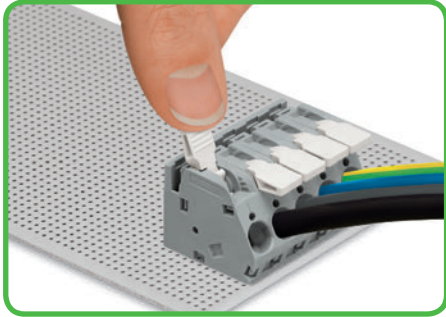
拉起操作杆 - 即可打开接线单元 - 2706和2716系列
