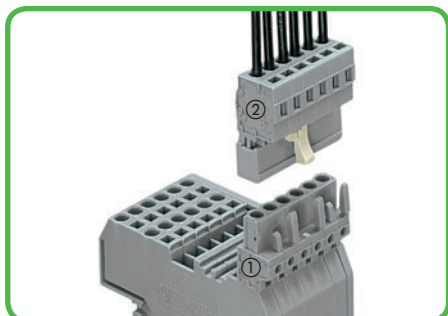
①*孔型插座, 带有直型长插针 ②*针型连接器, 具有笼式弹簧接线单元
