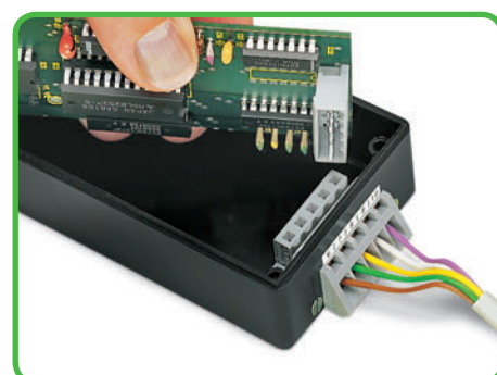
斜面出线的孔型连接器用作“穿墙式”连接。连接器的接线及其他操作均在机箱外部进行。机箱壁厚度最大为2mm。
