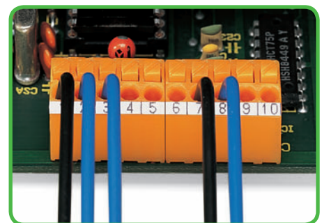
当2个PCB端子排排排使用时, 相接处的焊针间距不变
