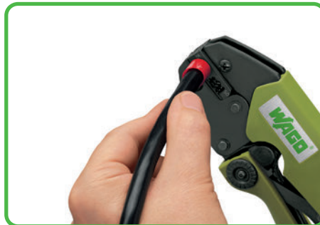
压紧手柄，直到棘轮装置松开。
