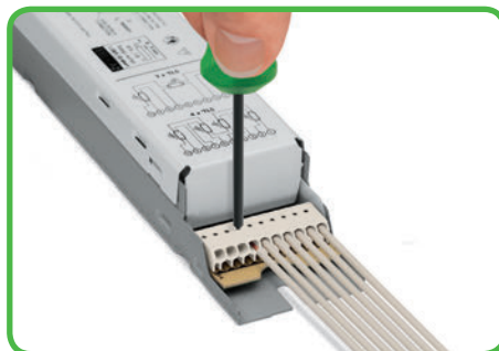
将拆线工具插入拆线孔后，拉出导线即可
