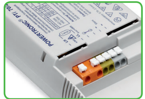
WAGO通过“内部跨越”的804系列端子排即可以不通过印刷电路板而实现保护接地连接。工厂可根据客户需要制作相互跨越的端子排，并对端子排做出标记。
