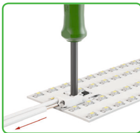
使用操作工具(如206-860)轻轻按下推压键便可连接 细多股导线或拆除导线
