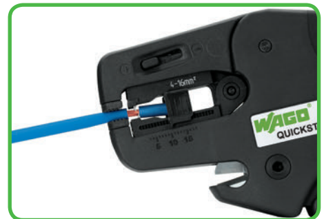
进行剥线操作
