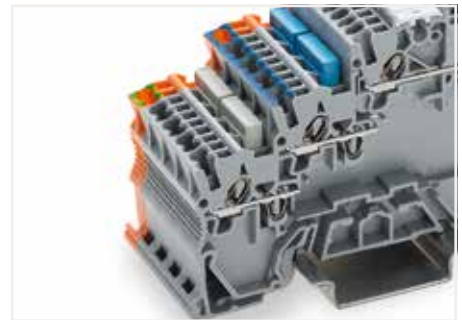
接地跨接: 对于不带保护接地的传感器/执行器专用接线端子, 可以通过与带接地脚的接线端子跨接而实现接地。
