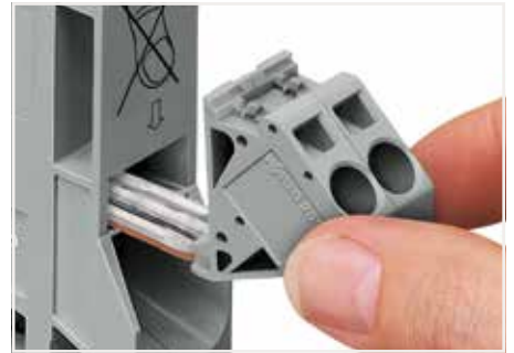
安全方便地为外接负载供电。当弹簧处于释放状态，即无导线插入时，可将等电位插头轻松插入接线端子的跨接器插孔。
