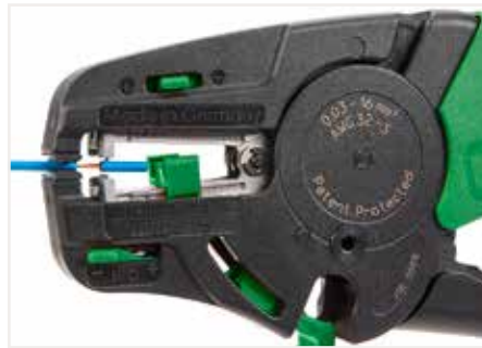
进行剥线操作。
