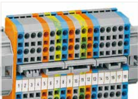
交错跨接器适用于较复杂的接线操作——跨接器要向下按压直到其完全压入。
