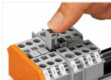
较大截面接线端子可以跨接到较小截面的接线端子上。 用力向下按压高低跨接器直到其完全压入。
