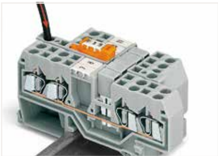
在供电侧使用可断开式接线端子，且该端子与其它普通接线端子相跨接，这样即可通过分断器控制所有的电源输出端。
