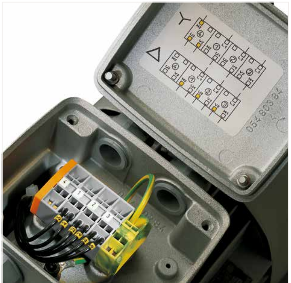
笼式弹簧连接技术： 插入导线。 当连接带冷压接头的导线时，需要选用比接线端子的额定截面积小一级的导线。
