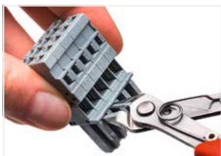
使用切割工具扭断孔型连接器上的防插错定位销。为了起到紧固作用，连接器两端的定位销不能扭断，当然也可额外使用锁定卡。
