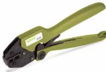
压线钳50，适用于带/不带绝缘护套的冷压接头，压线范围：35 mm 2 (2 AWG)和50 mm 2 (1/0 AWG)
