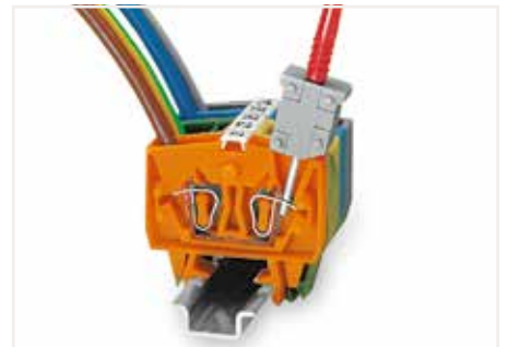
在导流条上使用笼式弹簧接线单元进行测试(最大额定电流：6 A) - 笼式弹簧接线单元连接单独测试触点。最大测试电压为400 V。
