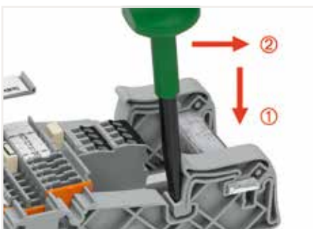
拆下固定架时, 用螺丝刀向下按压①然后向一侧拉动②。
