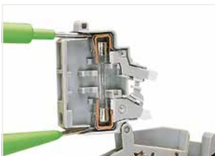
在保险丝盒断开情况下，测量保险管的通断。(无电压)
