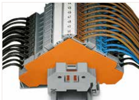
由于保险丝插头比该接线端子厚1mm，因此在使用保险丝插头时要使用隔板来弥补端子的厚度。
