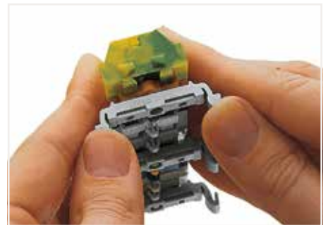
端子排，带有固定销钉，组装固定销钉(209-123) (固定销钉之间的距离约为 20 - 25 mm)
