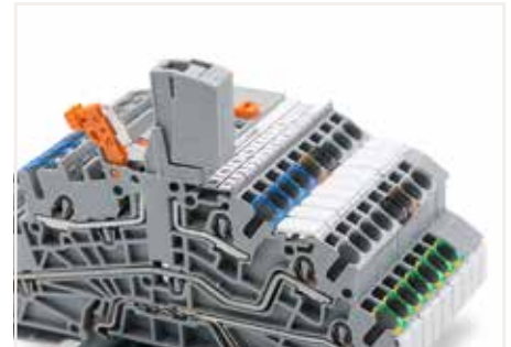
带内部N线分断的多层电气安装用接线端子，N线电位断开时可将测试插头适配器插入到自由垂直测试孔中。
