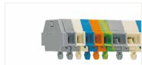
端子排, 带有固定销钉, 适用安装板厚度0.6 - 1.2 mm, 固定孔Ø 3.5 mm, 可安装到210-154铝质导轨上, 或通过209-120导轨安装支架安装到DIN 35型导轨上
