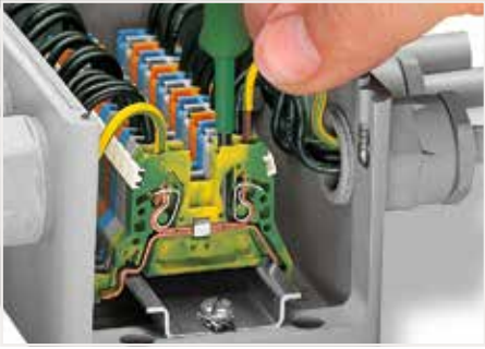
笼式弹簧连接技术： 使用操作工具插入导线(0.08 - 4 mm² "f-st")。 当连接带冷压接头的导线时，需要选用比接线端子的额定截面积小一级的导线。
