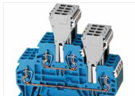
分接模块组件可直接插入导流条的跨接器插孔中。接线端子也可以使用梳状跨接器平行跨接至模块所使用的跨接器插孔。
