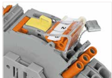
连接在端板(2007-8893或2007-8894)上的锁定铅封可将分断手柄锁定在工作状态。
