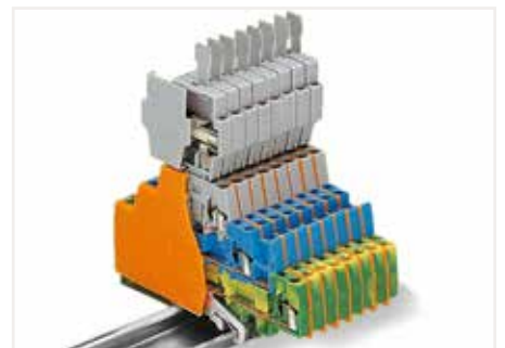
由于保险丝插头的厚度(6 mm)大于280系列三层接线端子(5 mm), 因此在使用保险丝插头时, 需要利用间隔板(厚1.1 mm)来补偿接线端子的厚度。
