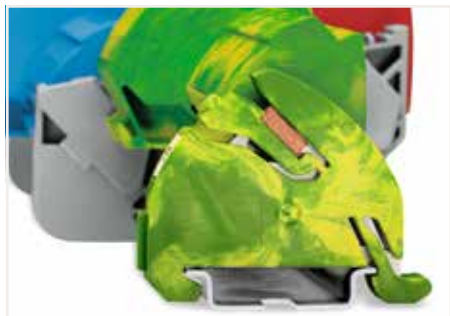
带接地脚的汇流条支架(812-141)： 该支架提供1个位置安装(10 x 3) mm汇流条。这样即可在汇流条和DIN 35型导轨之间形成自动连接。汇流条的一端放在812-141支架上，另一端放在812-140支架的中间位置上(见图)。
