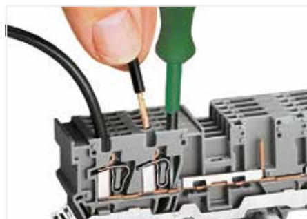
基础接线端子：使用螺丝刀(刀口尺寸3.5 x 0.5 mm)进行接线和拆线操作。
