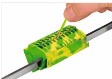
连接导线(4 mm 2 /12 AWG)： 通过直插型笼式弹簧接线单元，单股导线可直接插入。12 x 4 mm 2 用于汇流条的端子排中，显著缩短了布线时间。
