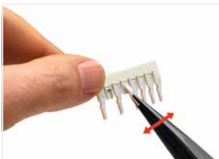
交错跨接器(7插脚)： 可根据需要扭断跨接器的插脚。相应位置的塑料托槽依然保留，用于保证一定的空气间隙和爬电距离。
