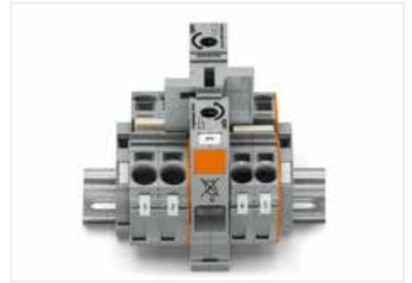
使用高低跨接器对35 mm 2 (2 AWG)大电流接线端子和TOPJOP® S 10/16 mm 2 (8/6 AWG) 2010及2016系列接线端子进行跨接 (不适于2016-76xx和2016-77xx)。
