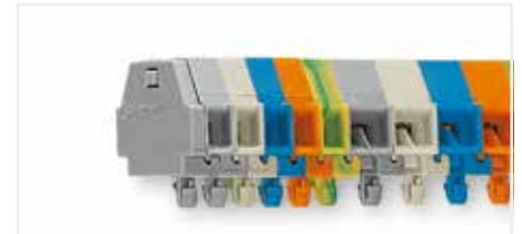
端子排, 带有固定销钉, 适用安装板厚度0.6 - 1.2 mm, 固定孔 Ø 3.5 mm, 可安装到210-154铝质导轨上, 或通过209-120导轨安装支架安装到DIN 35型导轨上
