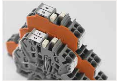
该垂直跨接器可将TOPJOB®S系列两层或三层接线端子的两个或者三个接线层跨接在一起。凭借产品表面清晰的数字标识("2"和"3")，即使在插入状态也可轻松辨别双层垂直跨接器(2002-492)和三层垂直跨接器(2002-493)。
