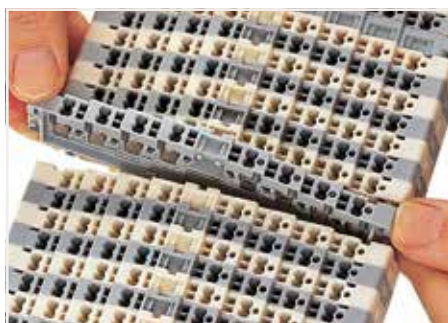
滑动接线端子将其从导轨上扳动拆下。
