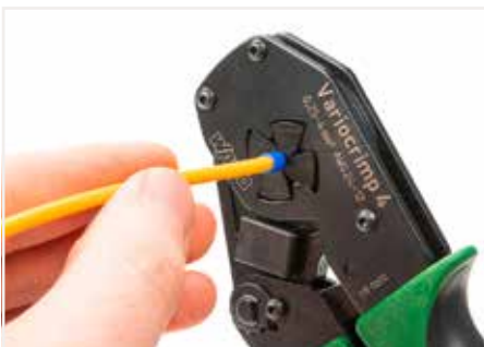
压紧手柄，直到棘轮装置松开。
