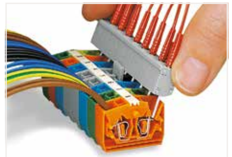
通过将触点与笼式弹簧接线单元的弹簧对接以执行测试(限制在0.5 A, 以及48 V测试电压) - 测试针无防触电保护功能。
