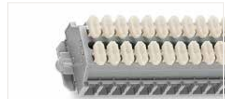
端子排，带有固定耳，适用于螺丝或相似安装类型，固定孔 Ø 3.2 mm，可通过209-123导轨安装支架安装到DIN 35型导轨上
