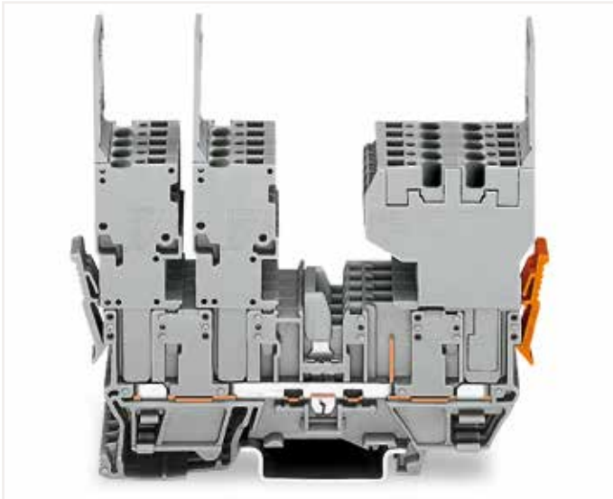
2 x 1线孔型连接器(左), 1 x 2线孔型连接器(右), 可调换顺序 - 使用280和780系列跨接器对基础接线端子进行跨接, 并使用测试插头适配器(280-4..)进行测试。
