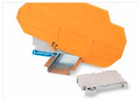
Ex e II/Ex i端子排 注意： 接线端子与分隔板的卡脚方向要求一致。
