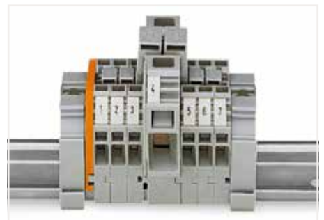
使用高低跨接器将16 mm 2 /6 AWG (283系列)与4 mm 2 /12 AWG (281系列)轨装接线端子进行跨接。
