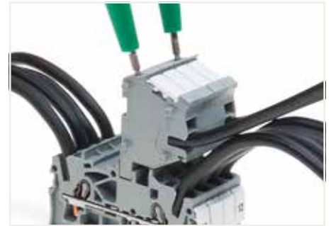
连接器带有直径2 mm的测试插孔，可使用2极电压测试器方便地进行电压测量。
