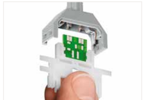
通过操作工具将PCB推入插头外盒。
