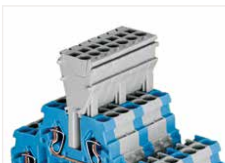
组装超过七个分接模块时，需要使用三个防逆装保护模块。
