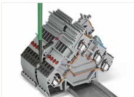
从DIN导轨上拆下接线端子。 注意：应先将端子上的跨接器拆下！
