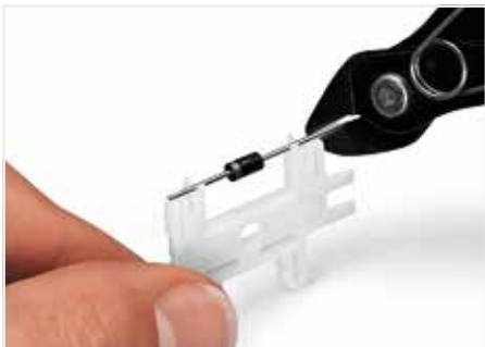
将元件切割成适当长度。
