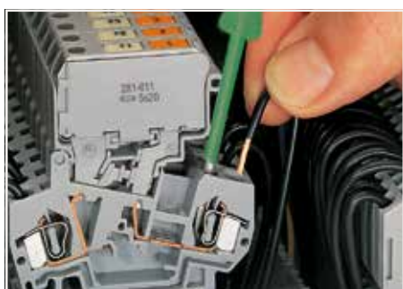
笼式弹簧接线单元 插入导线。 当连接带冷压接头的导线时，需要选用比接线端子的额定截面积小一级的导线。
