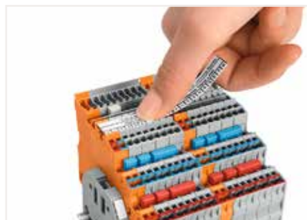
使用标记条(2009-110)或3.5 mm WMB标记牌(793-35xx)在接线端子上方或侧方进行标记。
