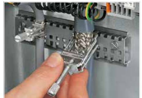
拆卸屏蔽线连接器时，只需将滚花螺丝拧松，然后将其轻轻取下。
