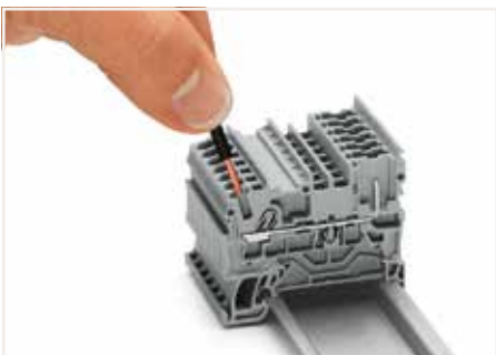
凭借直插型笼式弹簧连接技术, 单股导线只需轻松插入接线单元即可完成接线操作。
