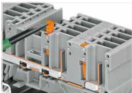
在基础接线端子上与之对应的位置插入定位销挡块，可起到防插错功能。如图所示，亦可将定位销挡块从端子上取下。
