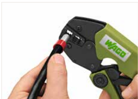
将加有冷压接头的导线插入压线孔。
