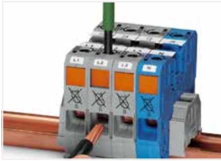
接线操作 - 步骤2： 将已剥好线皮的导线插入进线孔，并插到底。将其保留在该位置上。
