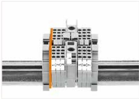
使用高低跨接器将6 mm²/10 AWG(282系列)与1.5 mm²/16 AWG(279系列)轨装接线端子进行跨接。
