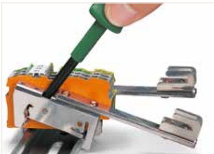
使用操作工具(3型, 刀口尺寸5.5 x 0.8 mm)拆下汇流条支架。
