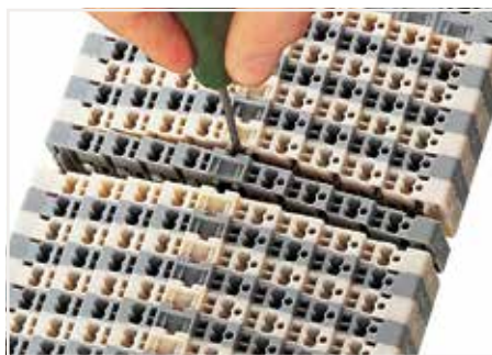
先用螺丝刀(刀口尺寸2.5 x 0.4 mm)将端子滑离端子排。
