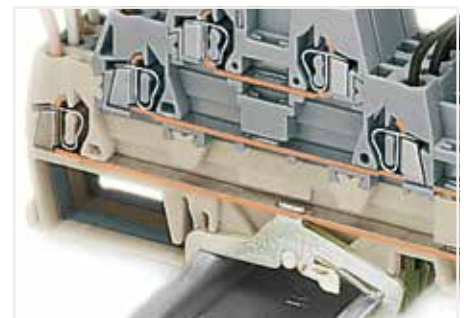
带有保护接地端子和屏蔽接地端子的三层接线端子, 底层具有接地脚可自动与导轨接触。标记支架置于导线上方, 在进行接线操作时会自然向一侧弯曲。该用来安装 WSB 标记牌的标记支架也分为上中下三层, 与下面的三层接线端子一一对应。该三层接线端子厚度为5 mm, 相当于每层接线端子的厚度仅为1.67 mm, 但它可连接截面积为0.08 mm 2 至2.5 mm 2 的导线!
