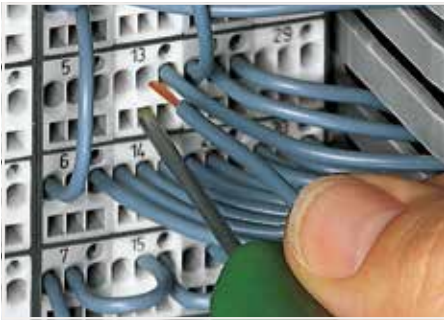
笼式弹簧连接技术 使用210-719螺丝刀(刀口尺寸2.5 x 0.4 mm)插入导线。
