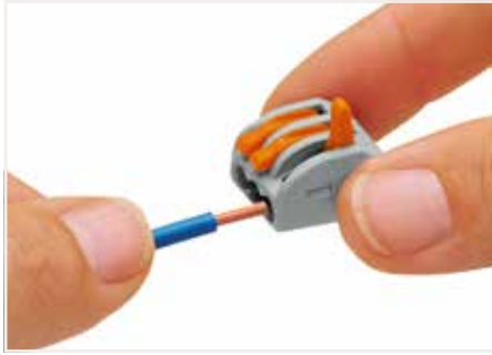
接线操作：扳动操作手柄打开进线孔，即可插入导线。
