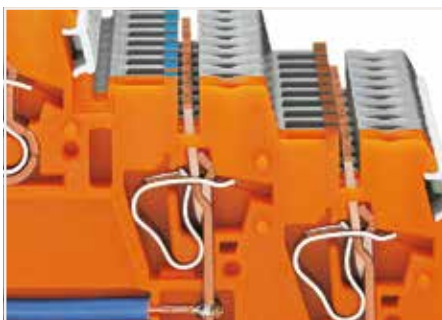
使用不带绝缘护套的梳状跨接器进行电源跨接，2路至9路或17路(2 x 8位)，具体取决于应用。
