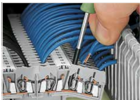
矩阵式接线端子： 在接线端子侧面接线孔插入/拆除导线。 当连接带冷压接头的导线时，需要选用比接线端子的额定截面积小一级的导线。
