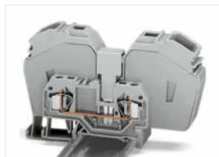
使用高低跨接器(283-414)对285系列接线端子(35 mm 2 /2 AWG)和281系列接线端子(4 mm 2 /12 AWG)进行跨接。
