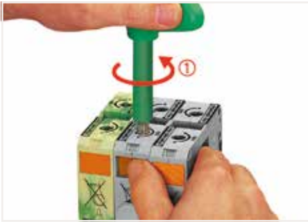
接线操作 - 步骤1: 使用内六角扳手逆时针旋转打开进线孔! 并使用插锁将进线孔保持在打开位置。
