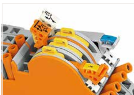
锁定器可以插在分断或闭合位置，用以防止无意中手柄的闭合或断开。
