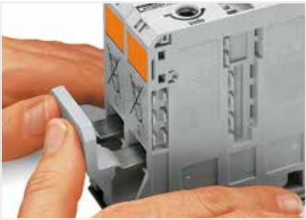
在导线连接之前，使用相邻跨接器进行跨接，无须使用工具，将跨接器直接插到导线进线孔上方的孔中即可，可连接导线的额定横截面积依然不变。
