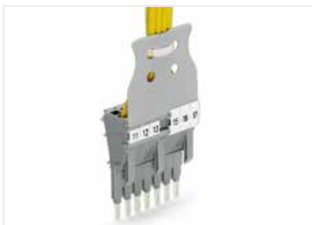
带有笼式弹簧接线单元的模块组件 (0.25 - 2.5 mm 2 /24 - 14 AWG), 包含护线板和适用于小型 WSB或WMB标记牌的标记位。
