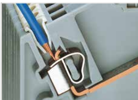
绝缘止动件： 可防止导线绝缘层插入到接线单元中。 (适用接线端子截面积最大4 mm²/12 AWG)
