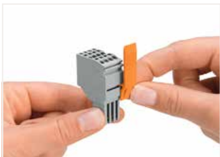
将锁定卡滑到孔型连接器的适当位置。
