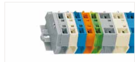
端子排, 带有固定耳, 适用于螺丝或相似安装类型, 3.2 mm 固定孔直径(带适于DIN 35型导轨的209-123固定销钉)
