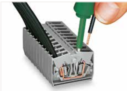
笼式弹簧连接技术： 插入导线。 当连接带冷压接头的导线时，需要选用比接线端子的额定截面积小一级的导线。
