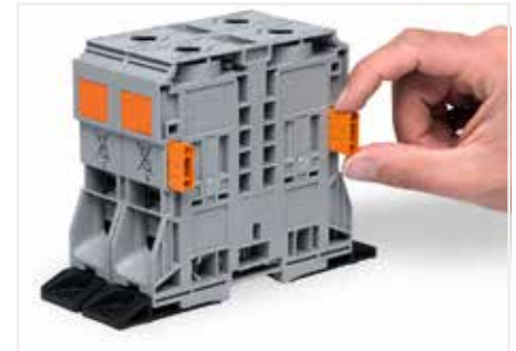
可将固定组件(285-1179)插入外壳插孔。
