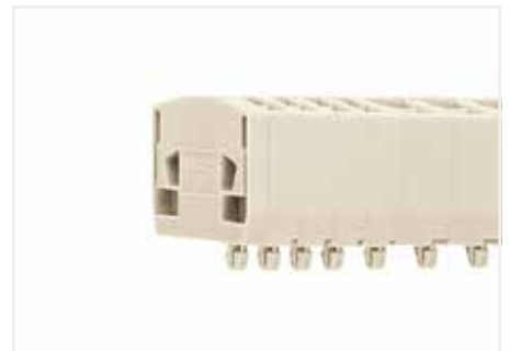
Ex e II端子排, 带有固定销钉, 适用于安装板厚度 0.6 - 1.2 mm, 固定孔Ø3.5 mm
