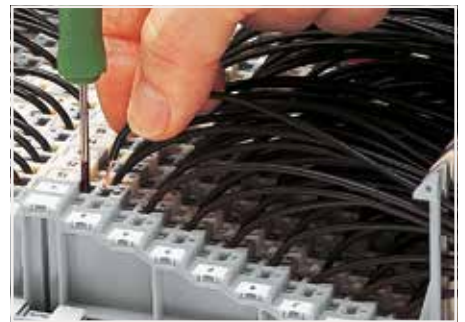
笼式弹簧连接技术 使用210-719螺丝刀(刀口尺寸2.5 x 0.4 mm)插入导线。 最大截面积：不带绝缘护套的冷压接头为1 mm 2 (18 AWG)， 带绝缘护套的冷压接头为0.75 mm 2 (20 AWG)
