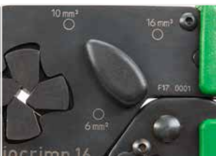
"Variocrimp 16"：压线之前应根据导线截面积将手柄调到相应的位置。
