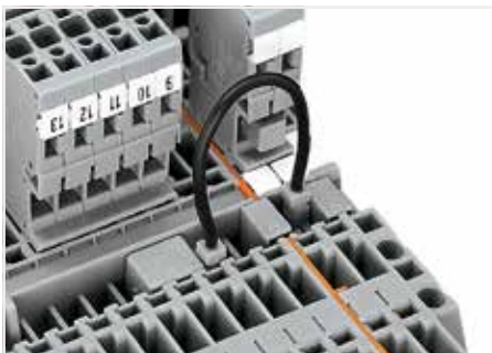
使用导线型跨接器或相邻跨接器对基础接线端子进行跨接 - 即使有隔板也可以。
