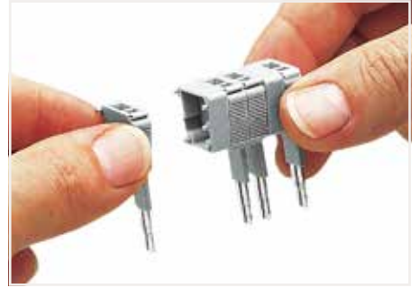
将测试插头模块和间隔模块组装成多极测试插头排(最多10极)。
