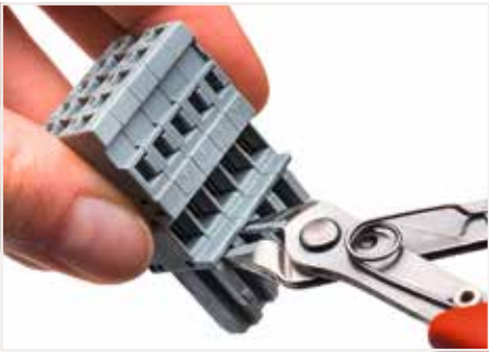
使用切割工具扭断孔型连接器上的防插锁定位销。为了起到紧固作用，连接器两端的定位销则不能扭断，当然也可额外使用锁定卡。
