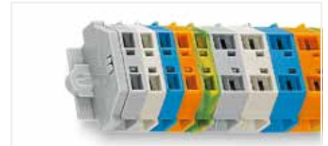
端子排, 带有固定耳, 适用于螺丝或相似安装类型, 固定孔 Ø 3.2 mm, 可通过209-123导轨安装支架安装到DIN 35型导轨上
