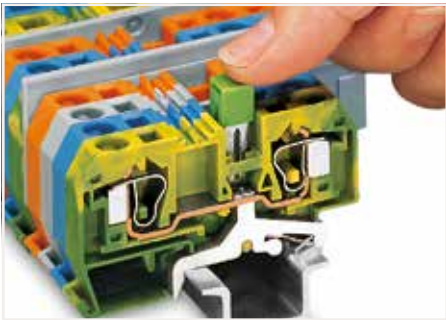
接地端子通过相邻跨接器与普通接线端子在端子 封闭一侧进行跨接。为标明该类端子，我们推荐使用黄绿混色的相邻跨接器。
