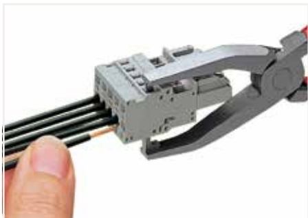
操作工具 插入导线 - 侧面接线(图示为孔型连接器)。 当连接带冷压接头的导线时，需要选用比接线端子的额定截面积小一级的导线。
