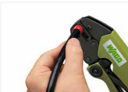
压紧手柄，直到棘轮装置松开。
