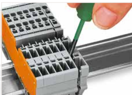
使用螺丝刀打开端子排，将单个端子滑离端子排，然后使用分离杆将端子从导轨上取下。
