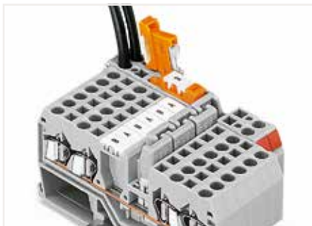
交错跨接器适用于较复杂的接线操作 - 跨接器要向下按压直到其完全压入。
