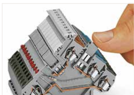
使用相邻跨接器(280-402)进行跨接。 将跨接器用力向下按压直至其完全压入。
