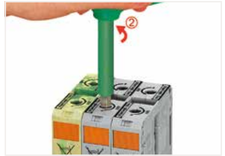
接线操作 - 步骤3: 将扳手逆时针稍转一下, 插锁自动解开。此时便可将扳手移开, 导线已经被牢固的连接到端子上。
