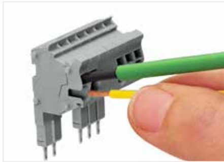
连接未经处理的多股绞合导线可以使用螺丝刀 - 连接单股导线可以直接插入。
