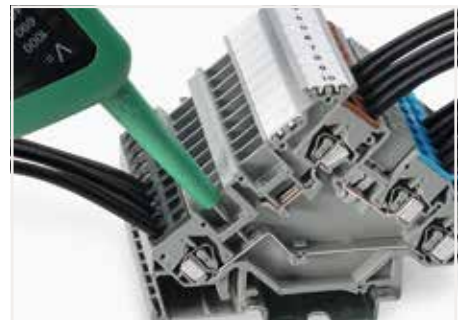
用电压测试器直接接触导流条进行测试。
