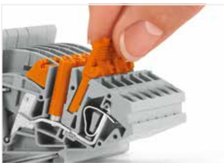
带翻板的跨接器 -通过提拉翻板将跨接器拔出。
