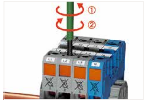
接线操作 - 步骤3： 将螺丝刀逆时针稍转一下，插锁自动解开①。此时将螺丝刀移开②，导线已经被牢靠的连接到端子上。
