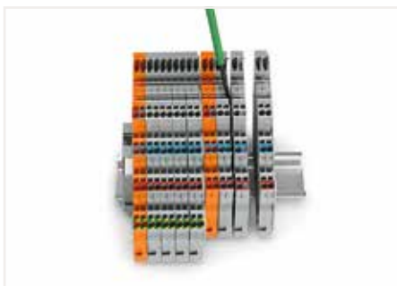
使用操作工具将安装好的接线端子排拆开，然后将单个接线端子滑离端子排，从导轨上取下。
