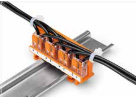
通过尼龙扎带将导线固定在支架上，以对线束进行保护 - 接线单元使用标记条(210-334)进行标记。
