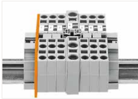
使用高低跨接器将10 mm²/8 AWG(284系列)与6 mm²/10 AWG(282系列)轨装接线端子进行跨接。
