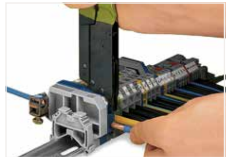
再压一下手柄，则操作钳松开，导线被压紧。取下操作钳，继续对下一个端子进行操作。
