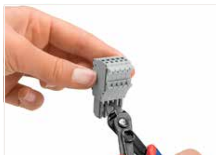
使用操作工具扭断防插错定位销。
