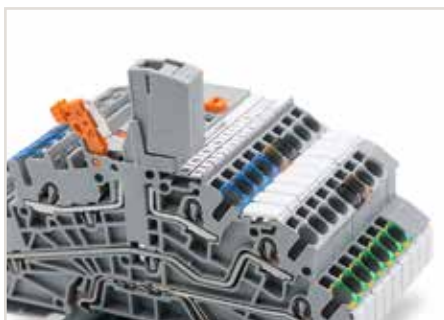
带内部N线分断的多层电气安装用接线端子，N线电位断开时可将测试插头适配器插入到自由垂直测试孔中。
