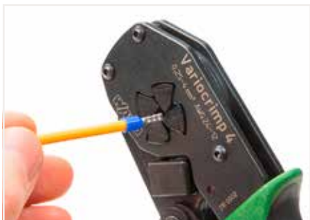
将加有冷压接头的导线插入压线孔。
