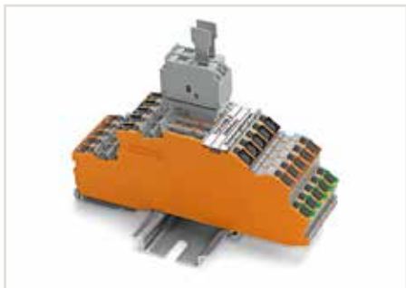
通过使用1mm厚的端板和隔板，单保险丝插头可以接插在不带N线刀型分断器的基础接线端子。
