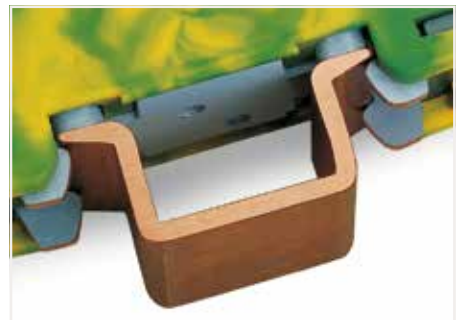
接地脚: 保护接地端子(根据EN 60947-7-2标准, 最大导线截面积 120 mm 2 /250 kcmil)必须安装到2.3 mm厚的铜质DIN导轨上。
