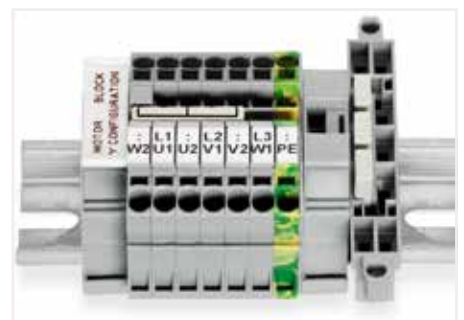
该跨接器专门用于建立“星形接法的公共点”，其应用领域为装有TOPJOB® S轨装接线端子的电动机端子板。
