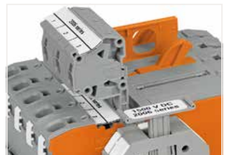
此外，也可使用模块化接插式连接器(2006-511，1-2极)进行测试。由于接线端子的厚度为15 mm，因此在应用中需要使用间隔模块(2006-549)来弥补接插式连接器的厚度。
