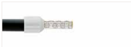
使用铜镀锡的冷压接头(经气密处理)采用防线芯散开措施会让导线直径增大，所以需要选择大一号的接线端子。
