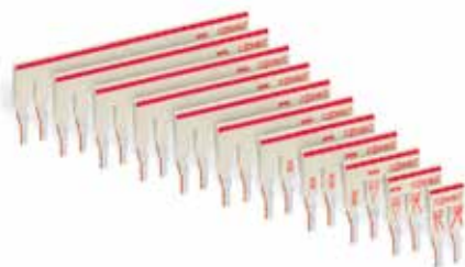
交错跨接器(7插脚)： 可根据需要扭断跨接器的插脚。相应位置的塑料托槽依然保留，用于保证一定的空气间隙和爬电距离。
