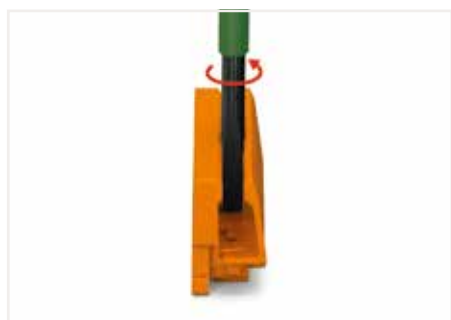
调整固定支架宽度：插入5.5mm螺丝刀揭开锁定装置，然后转动螺丝刀将支架内的夹持滑块推到所需宽度。
