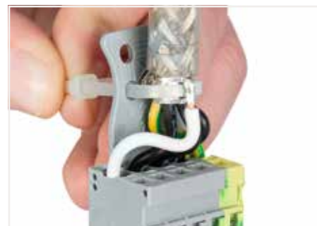
使用尼龙扎带将屏蔽线缆和屏蔽线/连接器过渡线可靠地固定在应变消除板上。
