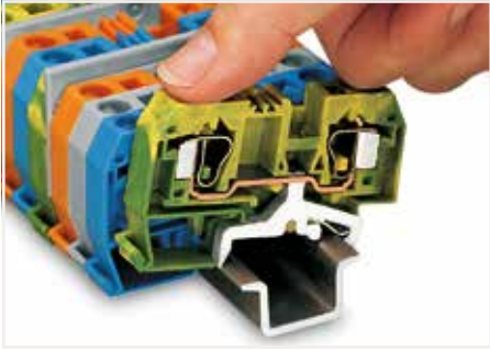
将保护接地端子卡装到DIN导轨上，即可自动与导轨之间实现直接电气连接。
