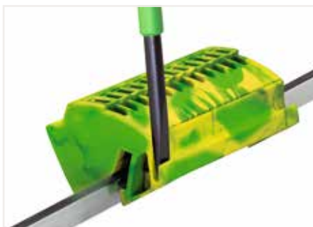
用螺丝刀撬开端子排两端的脱扣装置。即可将接地端子排从汇流条上取下。
