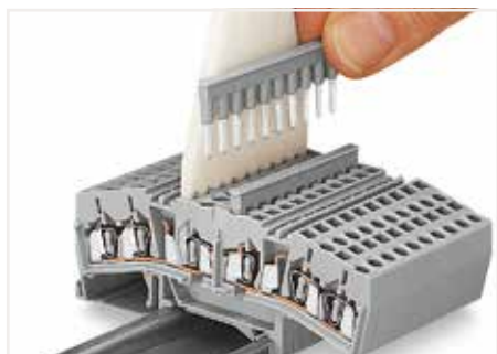
增加电位接点 使用10插脚梳状跨接器。 (只能在接线端子中央使用)
