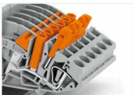
带翻板的跨接器 -将跨接器插入普通电流互感器用接线端子，此时因为翻板未打开，所以无法完全插入。
