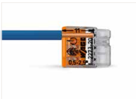
剥去单股导线绝缘外皮11mm (详见标记)。
