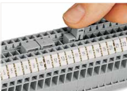
使用相邻跨接器(280-402)进行跨接。 用力按压跨接器直至其完全压入。
