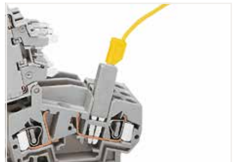
可使用测试插头适配器280-404(如图所示)或测试插头281-407在输入端进行电压测试。
