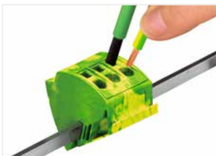
连接导线(16 mm 2 /6 AWG)： 适用于单股导线、多股绞合导线和细多股导线，接线时，需用螺丝刀打开导线进线孔。
