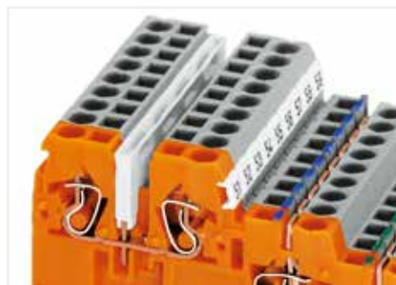
使用带绝缘护套的梳状跨接器(870系列)跨接信号层电源 - 2路至9路，具体取决于应用。 带LED指示灯的传感器专用接线端子无法跨接!
