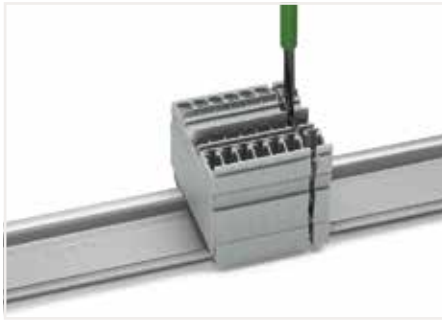
使用螺丝刀(刀口尺寸3.5 x 0.5 mm)滑动拆开端子排。
