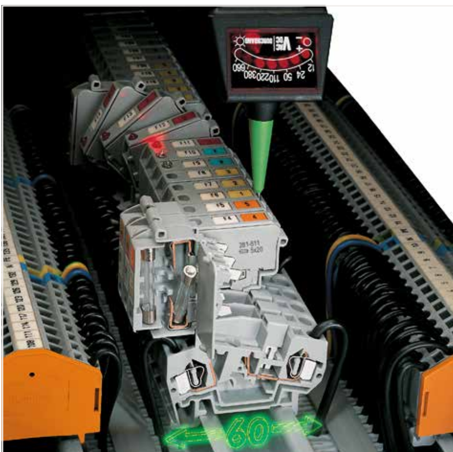
笼式弹簧接线单元 插入导线。 当连接带冷压接头的导线时，需要选用比接线端子的额定截面积小一级的导线。
